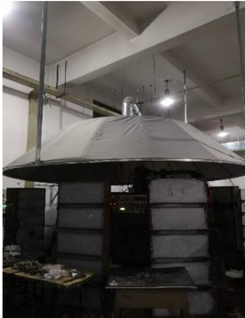
图 7-12 一号板和二号板内芯浇注吸风罩及管道
